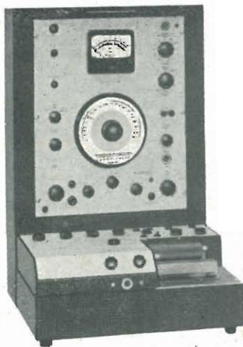
Fig. 7 - Registratore automatico di risposta in frequenza Mod 3304 costituito da un oscillatore di frequenza a battimenti Mod 1014 e da un registratore di livello Mod. 2305. Il moto della carta del Mod. 2305 è meccanicamente accoppiato e sincronizzato alla variazione logaritmica di frequenza fra 20 Hz e 20 kHz del Mod. 1014. La tensione di uscita del Mod. 1014 è costante entro -0,3 dB in tutto l'intero campo di frequenze.
