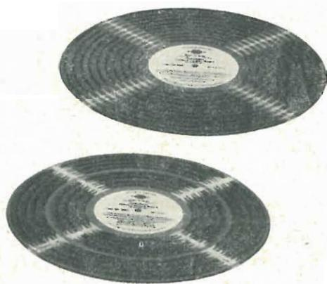
Fig. 1 - Dischi di frequenza scivolante QR2007 (monofonico) e QR2009 (stereofonico).
